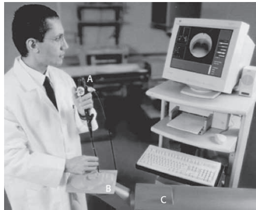
Figura 9. Simulador de fibroscopio flexible (53) . A: FF sección proximal; B: maniquí con puerto de inserción; C: equipo de interface.
